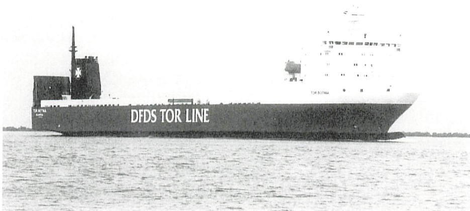
欧州の短距離国際航路に就航するRORO型貨物船。速力が比較的速いのでEEDIは必然的に高くなる。
